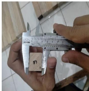
Pengukuran dimensi contoh uji
