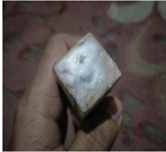
Setelah dilapisi lilin
