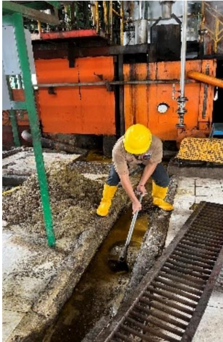
Gambar 4.2 Pembersihan parit pada stasiun klarifikasi
