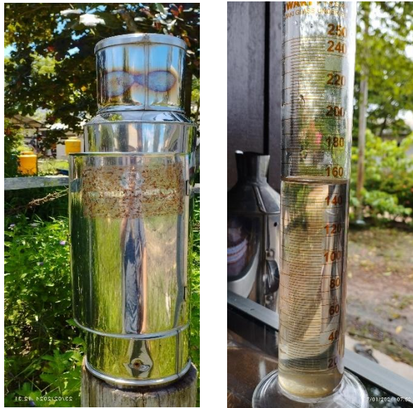
Gambar 7. Kalibrasi Pada Ombrometer Observation (OBS)
