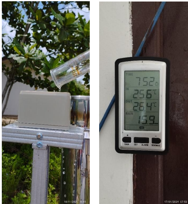
Gambar 8. Kalibrasi Pada Ombrometer Wireless Rain Gauge
