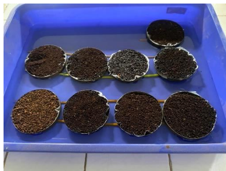
Lampiran 1. 4 Proses Analisa Kadar Lengas Maksimum
