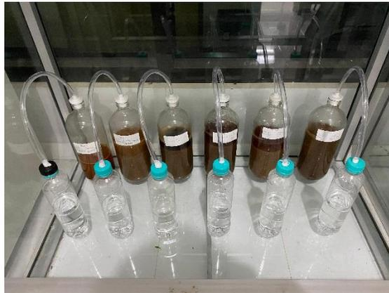
**Gambar 5. Rangkaian botol fermentasi Larutan pembuatan Bioetanol**
