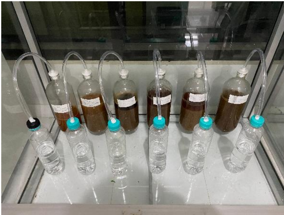
Gambar 3. Rangkaian Botol Fermentasi Larutan Pembuatan Bioetanol
