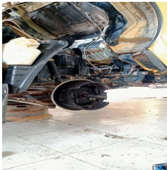
5 Gambar 3. Kerusakan dump truck pada komponen bearing
