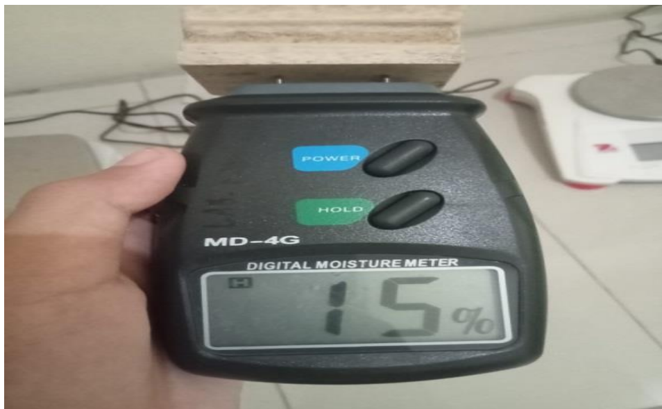
Pengukuran kadar air menggunakan Moisture meter
