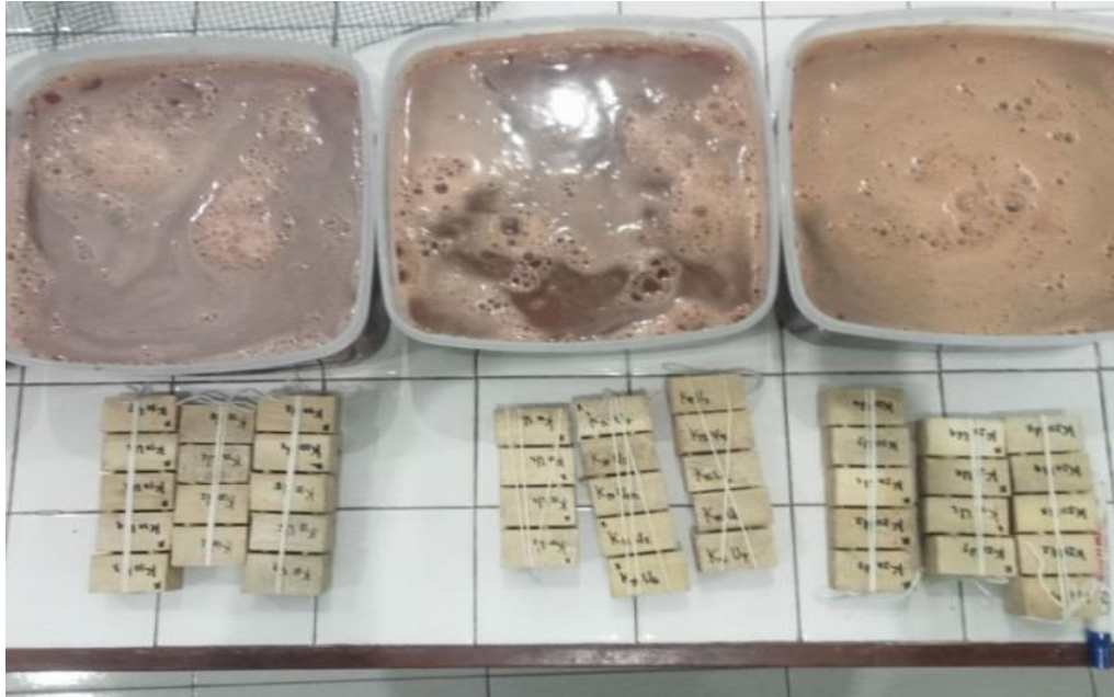
Proses persiapan contoh uji ebelum direndam pada larutan ekstrak serbuk kayu ulin
