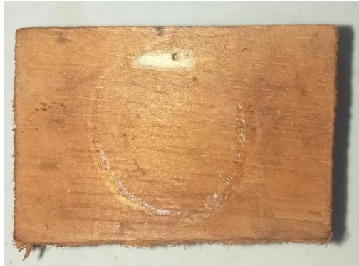
Kondisi contoh uji setelah diumpankan rayap kayu kering selama 1,5 bulan (formula 15%)
