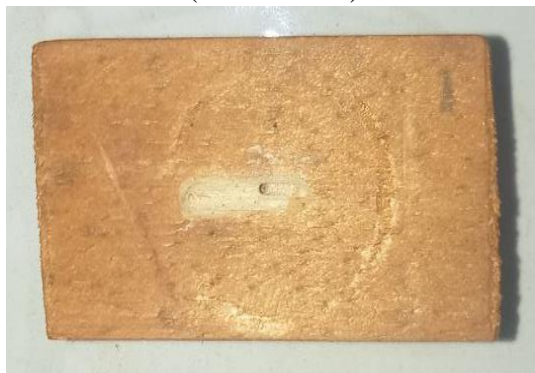
Kondisi contoh uji setelah diumpankan rayap kayu kering selama 1,5 bulan (formula 10%)
