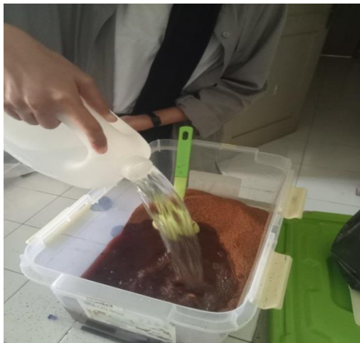
Pelarutan serbuk ulin dengan etanol
