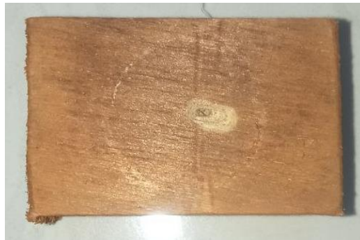
Kondisi contoh uji setelah diumpankan rayap kayu kering selama 1,5 bulan (formula 20%)
