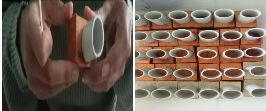
Penempelan paralon pada contoh uji kayu jabon
