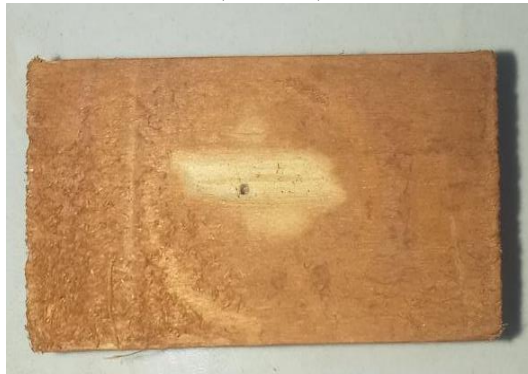
Kondisi contoh uji setelah diumpankan rayap kayu kering selama 1,5 bulan (formula 5%)
