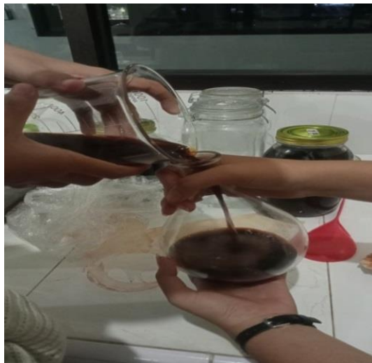
Larutan serbuk kayu ulin dimasukkan ke dalam labu alas bulat
