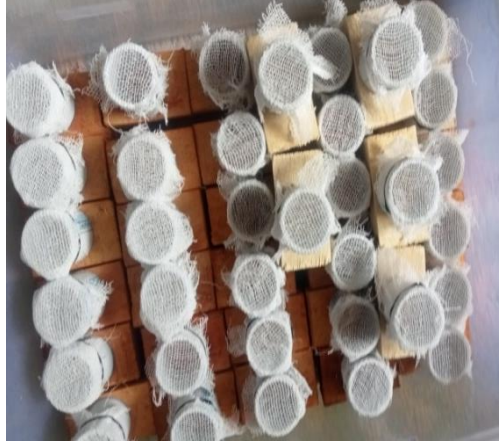
Penutupan contoh uji menggunakan kasa
