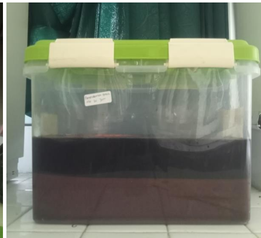
Pengendapan larutan serbuk kayu ulin selama 24 jam
