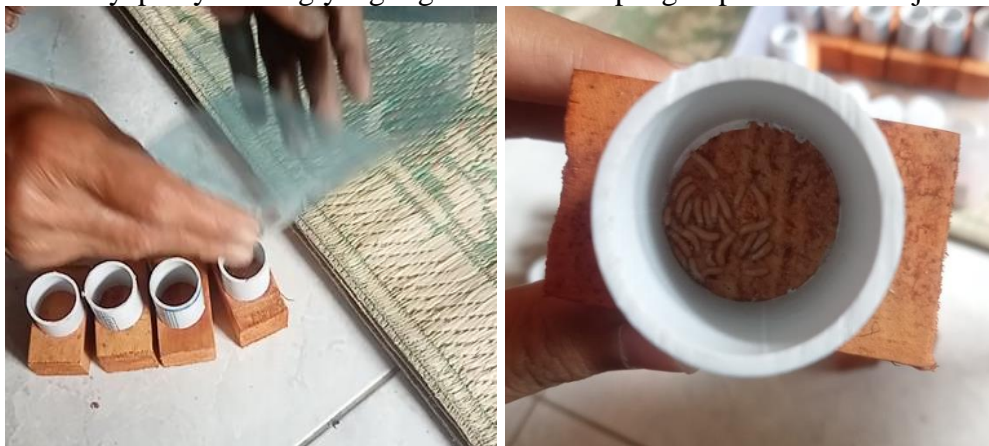
Proses memasukkan rayap kayu kering ke dalam contoh uji sebanyak 25 ekor
