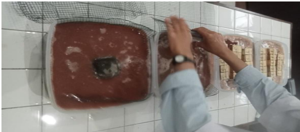
Proses perendaman contoh uji pada larutan ekstrak serbuk kayu ulin
