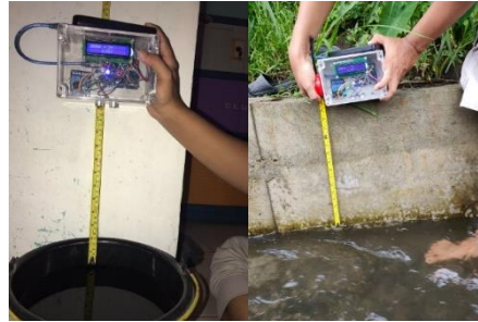
Gambar 6. Alat Deteksi Banjir Berdasarkan Proses Kalibrasi Prototipe Berbasis Datalogger
