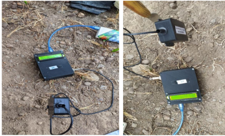
Gambar 5. Kalibrasi pada Alat Ukur pH Tanah buatan
