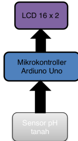
Gambar 3. Diagram blok koneksi deteksi pH tanah.
