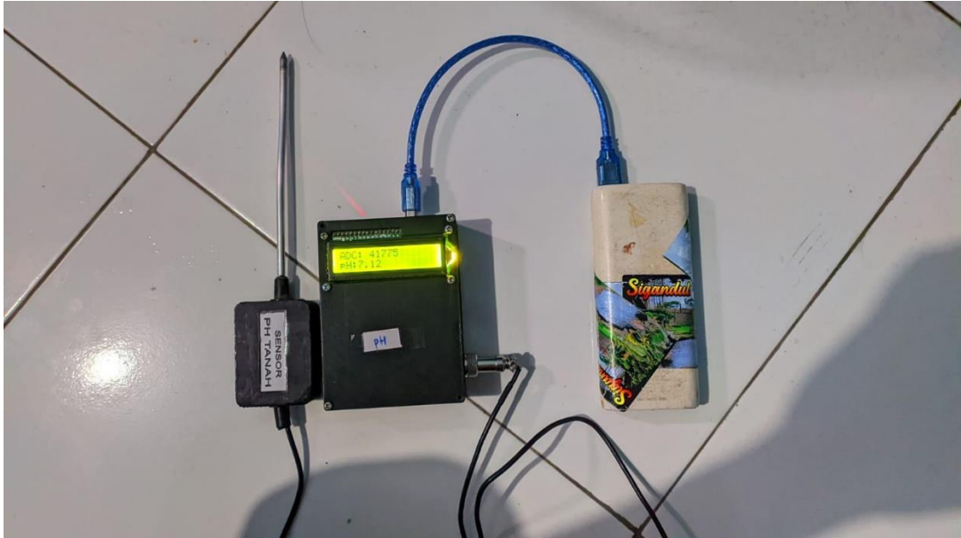
Gambar: Hasil penelitian rancang bangun alat ukur pH tanah berbasis Arduino uno
