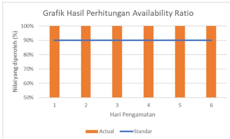
Berdasarkan hasil yang diperoleh dari perhitungan untuk nilai *availability* selama 6 hari yaitu 100%. Dan hal ini mengartikan bahwasannya nilai *availability* mesin press selama 6 hari masih di atas standar *availability* yaitu > 90%. Untuk Jam kerja tertinggi pada hari ke 4 dengan 96 Jam dan yang terendah pada hari ke 6 dengan 85,92 Jam, serta untuk Jam keseluruhannya hasil yaitu 545,58 Jam.
