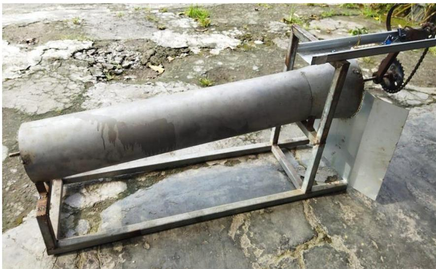
**Gambar 4.2.** Hasil perakitan turbin screw Mikro Hidro
