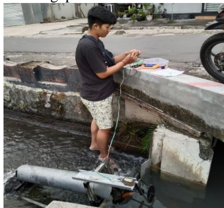
Pengujian turbin generator
