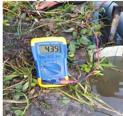
Pembacaan voltase generator
