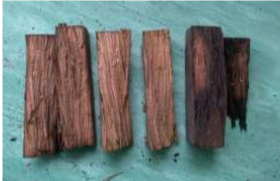
Gambar 5. Hasil kayu glugu yang di belah setelah dileburkan untuk melihat hasil resapan larutan plastik.
