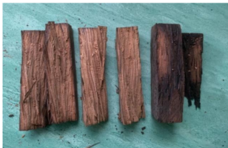
Gambar 5. Hasil kayu glugai yang di belah setelah dileburkan untuk melihat hasil resapan larutan plastik.
