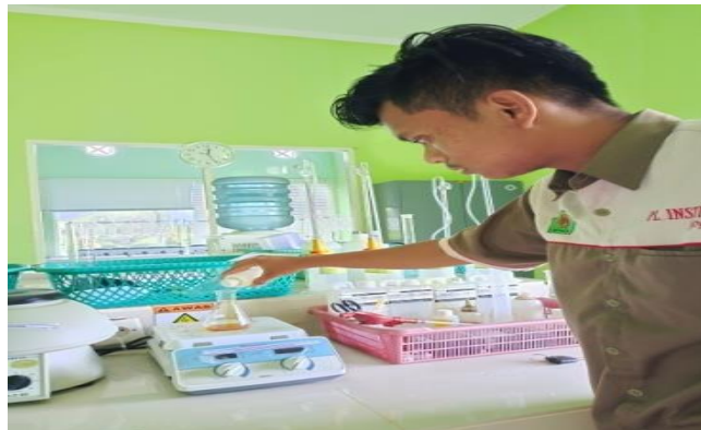
Gambar 10. Mencampurkan Cairan Alkohol, Titrasi, dan Nho180 lalu menghitung kandungan ALB dan Rendemen
