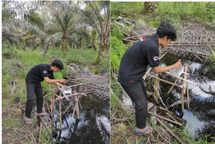
Gambar 1.6 pembuatan stand dan pemasangan alat Awlr
