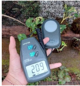
Pengukuran intensitas cahaya menggunakan lux meter
