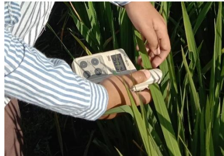
Gambar: Pengukuran menggunakan SPAD-502 Minolta
