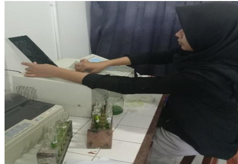
Gambar: Pengukuran dengan spektrofotometer UV-Vis
