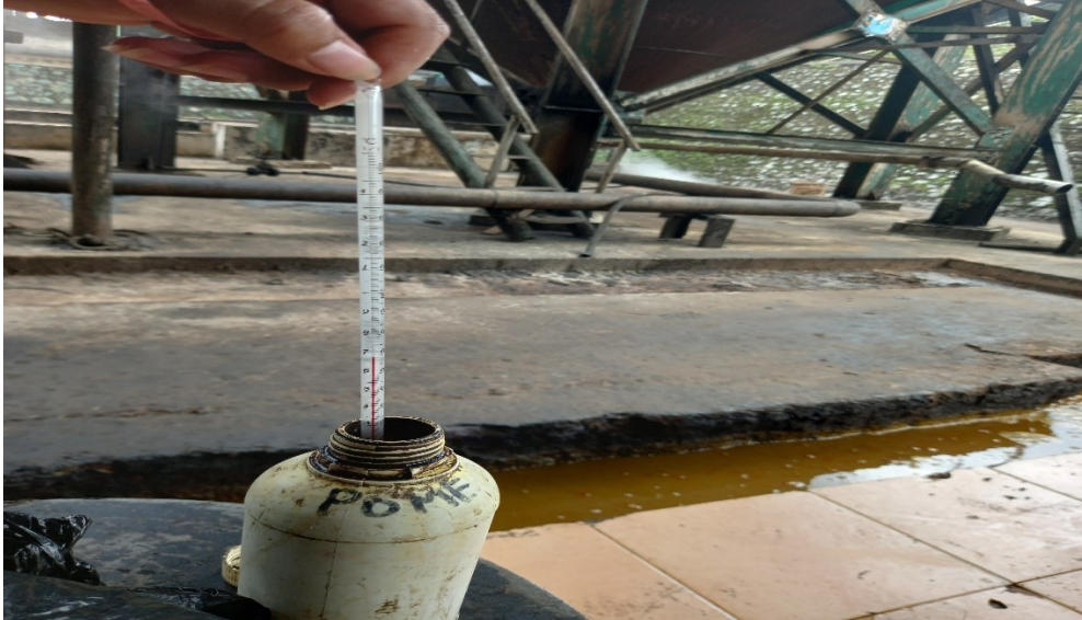
Pengukuran suhu final effluent
