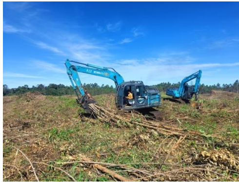
Gambar 3. Excavator Grapple meng-ekstrak kayu ke Tpn
