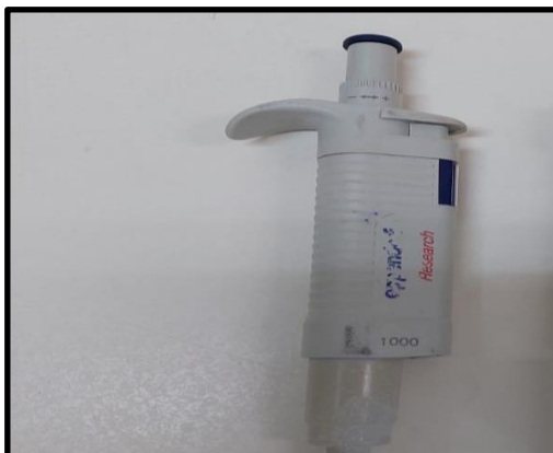
Menggunakan 1 ml pipet tetes untuk mengambil larutan Trichoderma sp.
