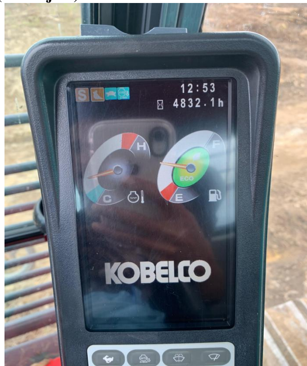
Lampiran 24. HM ( Hours meter ) pada excavator KOBELCO yang berumur (>4000 jam)
