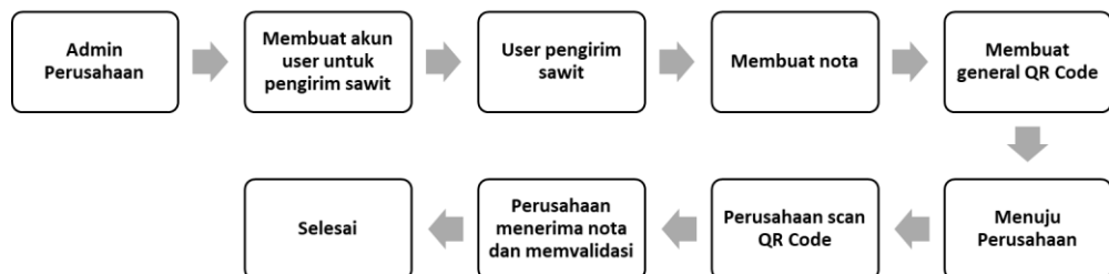
Gambar 4. Diagram kasus perancangan aplikasi SPB Digital berbasis android.
