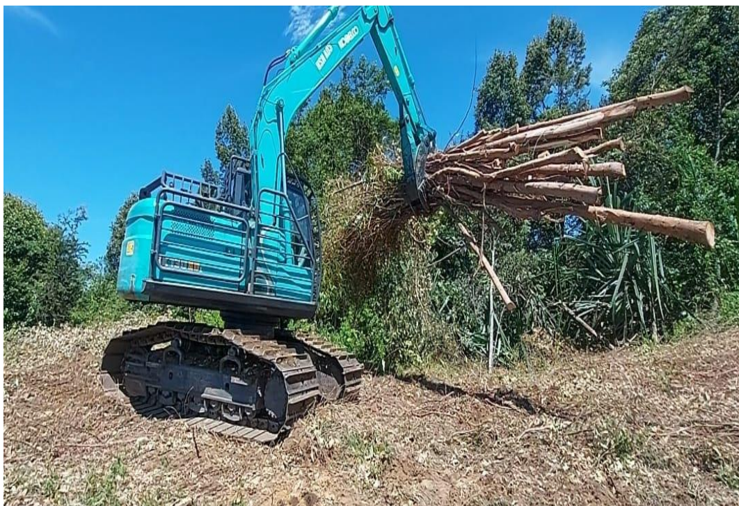
Lampiran 8. Excavator Kobelco meng-ekstrak kayu ke TPn
