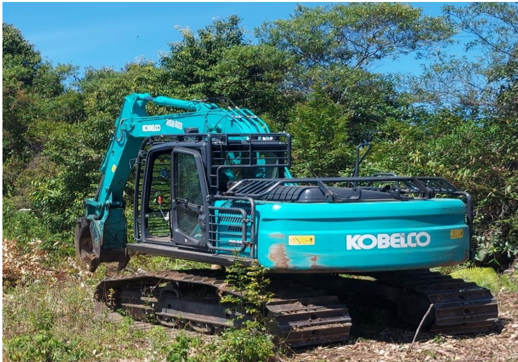
Lampiran 8. Excavator Kobelco meng-ekstrak kayu ke TPn
