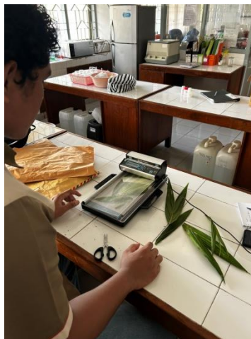
Gambar 12. Pengukuran luas daun dengan LAM ( leaf area meter )
