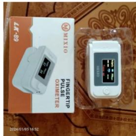
Gambar 4. 6 Oximeter (Alat Ukur Detak Jantung)
