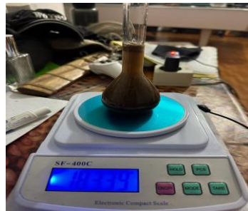
Gambar 17. Pengukuran Berat Jenis Tanah
