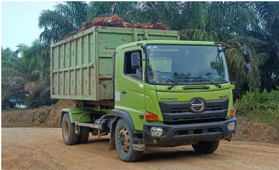
Gambar 3. Bin System Untuk Evakuasi TBS
