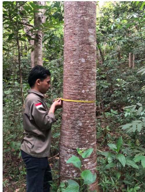
Mengukur diameter pohon menggunakan pitameter
