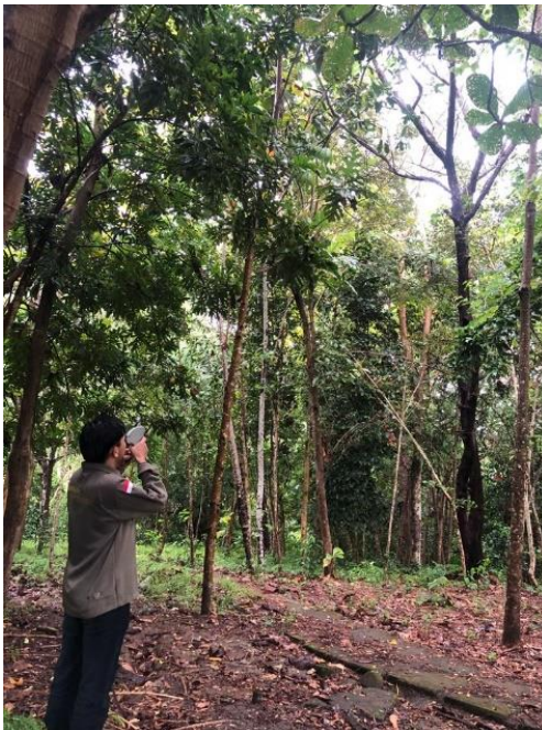
Mengukur tinggi pohon menggunakan haga
