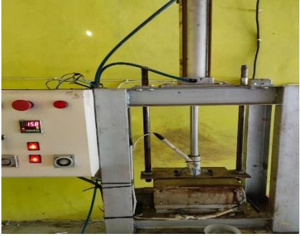
Pencetakan pada alat thermopressing
