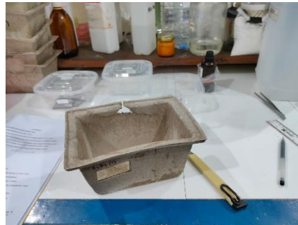
Pemotongan sampel densitas dan ketebalan
