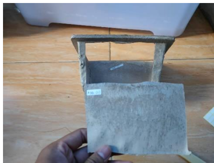
Pemotongan sampel analisis kuat tarik
