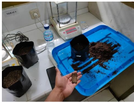
Penimbangan sampel biodegradability setelah dikubur 14 hari
