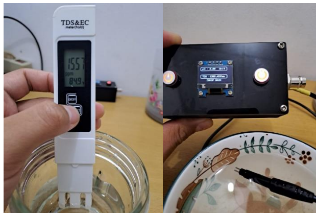
Gambar 4.4 TDS meter pabrikan dan cairan pengujian
