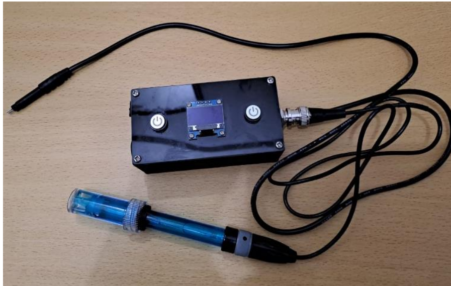
Gambar 4.1 Hasil rancangan alat kualitas air tampak luar
