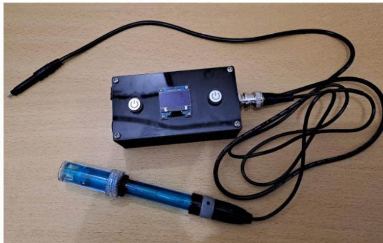
Gambar 4.1 Hasil rancangan alat kualitas air tampak luar
