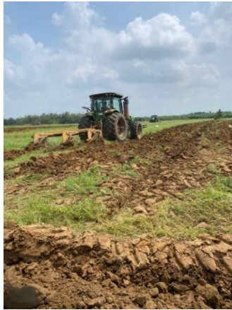
Gambar 4. Proses pembajakan bajak singkal
