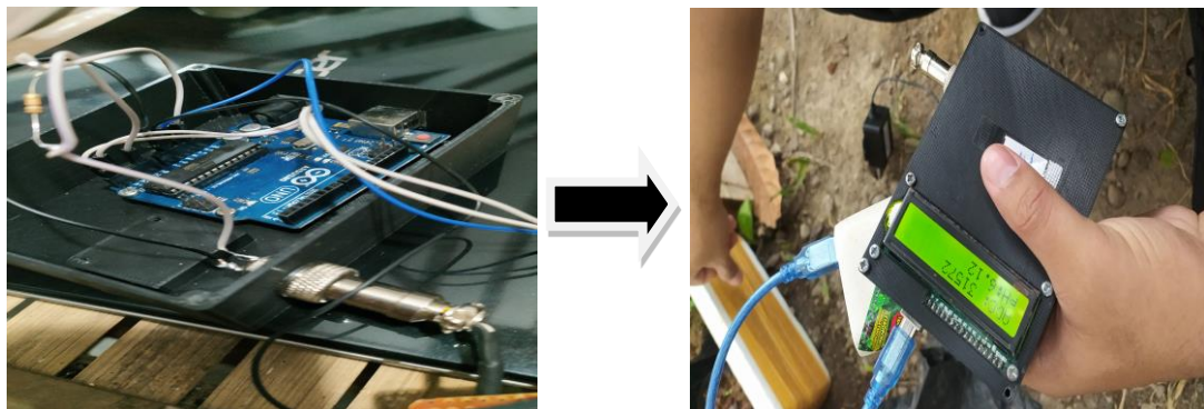
Gambar 2. Desain alat otomatisasi alat ukur pH tanah
