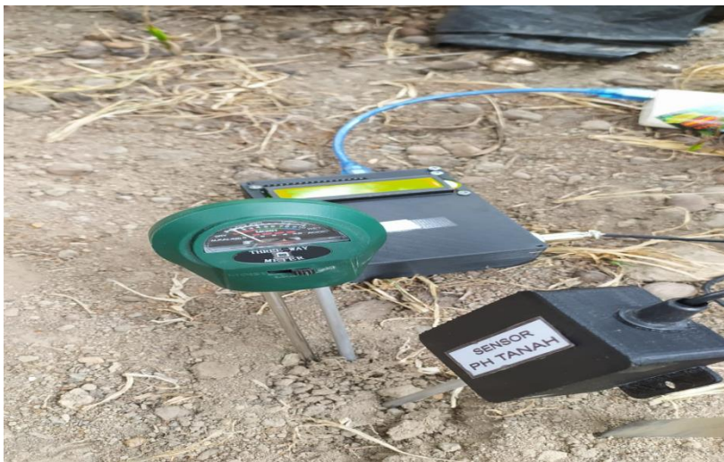
Gambar 3 Kalibrasi perbandingan alat pH tanah dan pH reference
