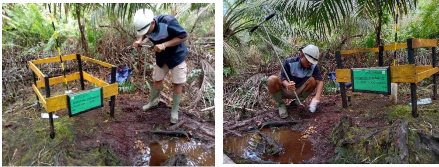
Gambar 4.6. pengukuran kedalaman pirit di lahan gambut
