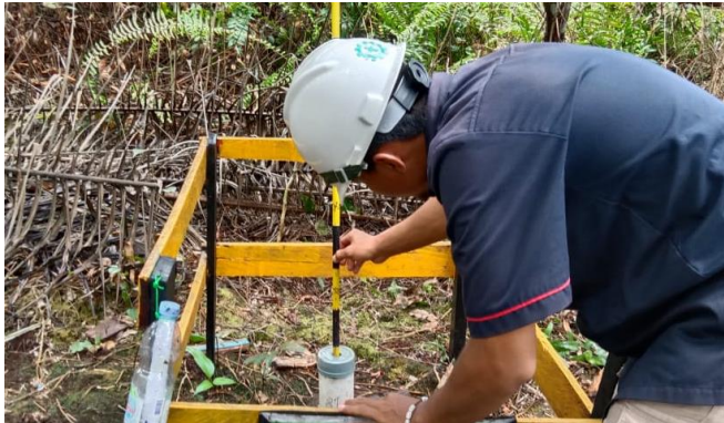
Gambar 4.8. Pengamatan piezometr M-58
