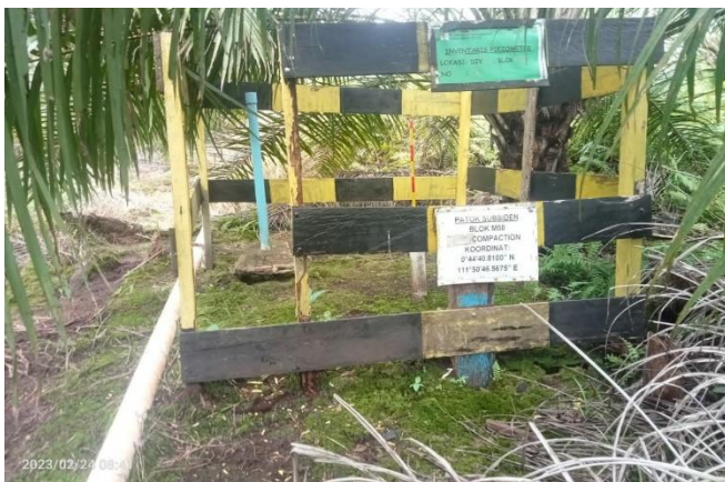
Gambar 4.9. Piezometer berdekapan patok subsiden
