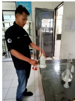
melakukan titrasi pengujian kadar FFA
