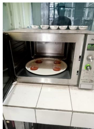
proses pengovenan untuk menghilangkan kadar air
