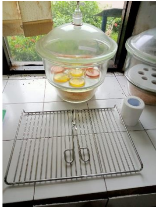
Proses pendinginan di desikator
