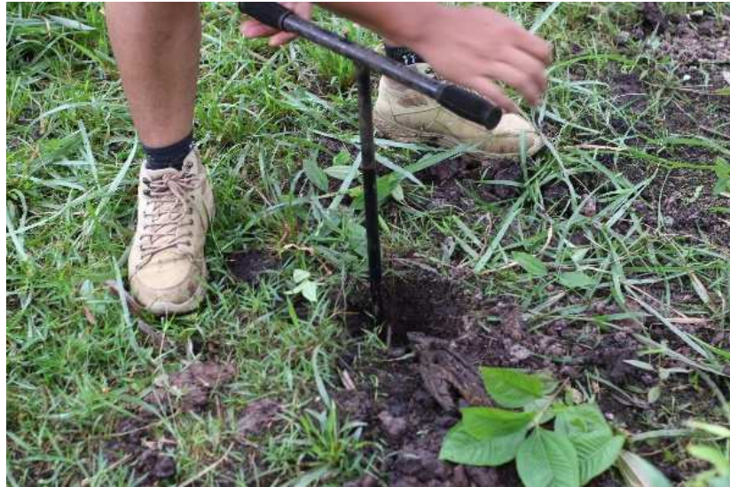
Lampiran 14 Pengeboran Lubang Peletakan Sensor
