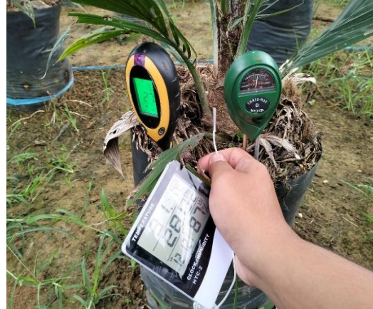
Pengukuran suhu dan kelembapan udara dengan Thermo-hygrometer
