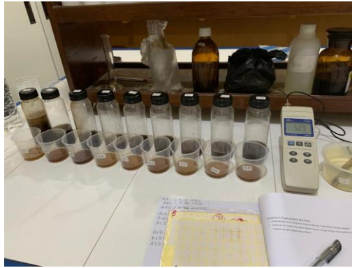
Analisis pH menggunakan pH Meter
