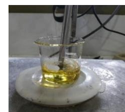
Pencampuran fase air kedalam fase minyak menggunakan agitator
