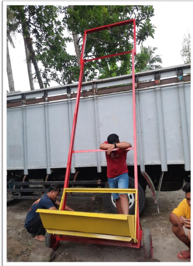
Lampiran 2. Gambar Alat Angkat Kelapa Sawit Dengan Menggunakan Electric Hoist
