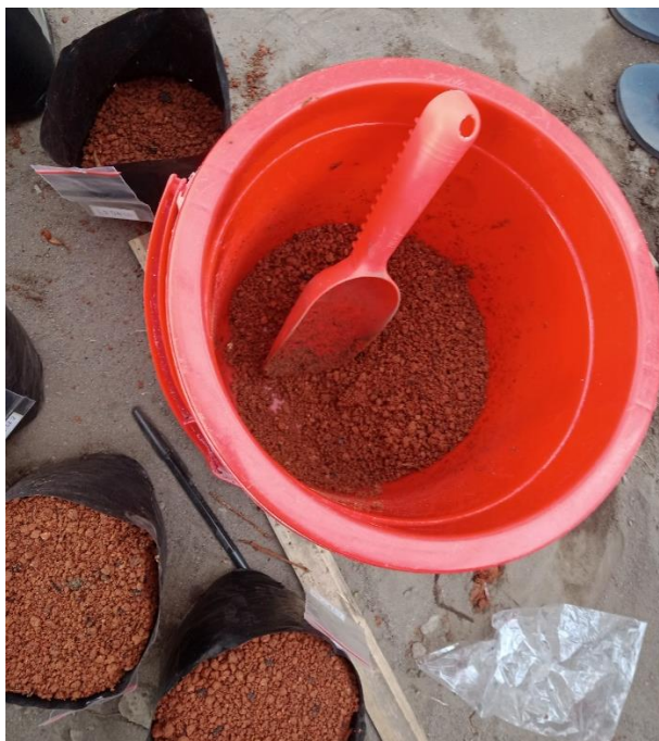
Gambar 2. Proses pencampuran tanah dengan abu limbah pertanian
