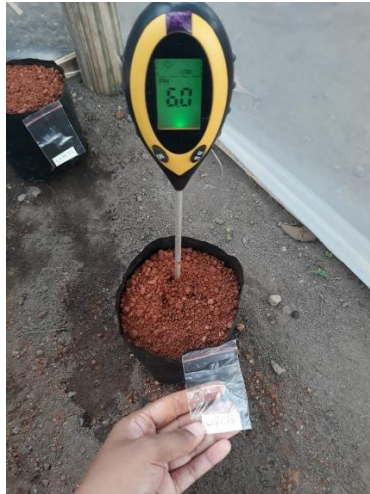
Gambar 5. Pengukuran pH tanah
