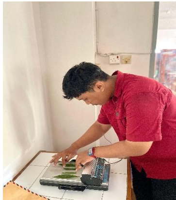
Gambar 8. Pengukuran daun menggunakan Leaf Area Meter
