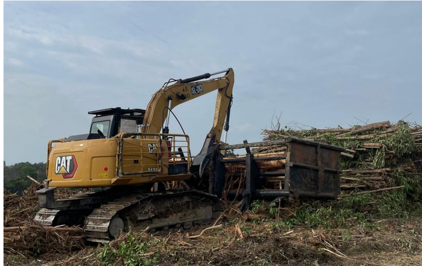
Proses Kegiatan Debarking Menggunakan Excavator with DPD
