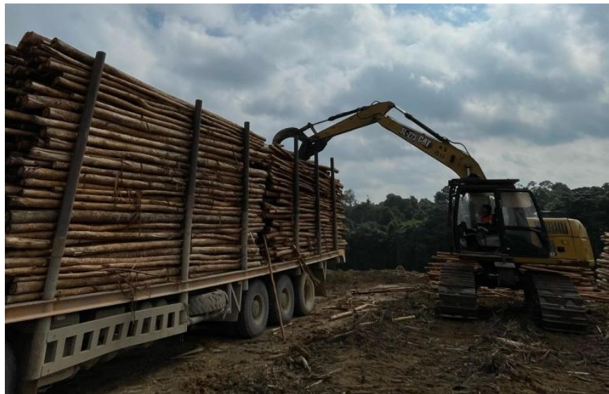
Proses Kegiatan Loading Menggunakan Excavator Fix Grapple
