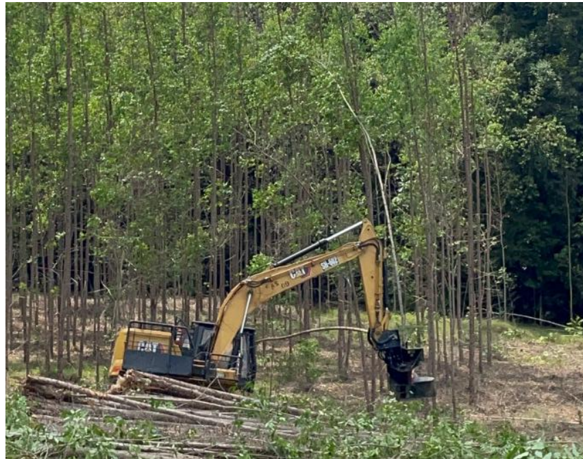
Proses Kegiatan Felling Menggunakan Shear Head
