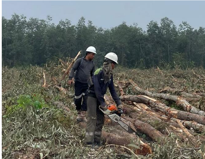
Proses Kegiatan Bucking menggunakan Chainsaw
