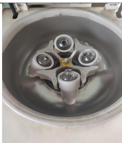
Proses sentrifugasi setelah proses transesterifikasi
