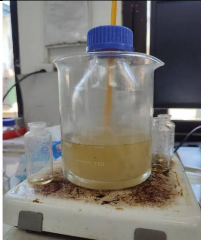
Proses washing menggunakan akuades dan citrid acid
