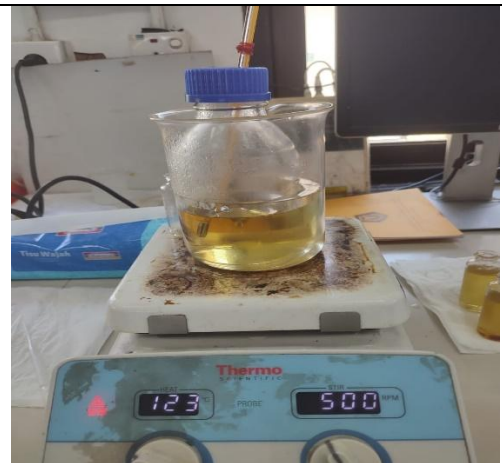
Proses transesterifikasi pada suhu 60°C
