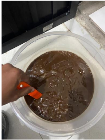
Perendaman bubuk Kulit Pisang dengan etanol 96%.
