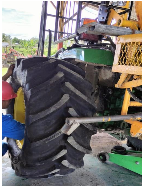
Gambar 11. Pemasangan Ban LGP Merk Mitas depan
