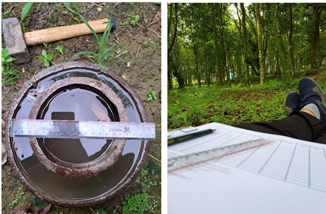
Gambar 12. Alat dan bahan pengambilan data laju infiltrasi, yaitu Double ring, penggaris, pulpen, palu, gelas ukur, dan air.
