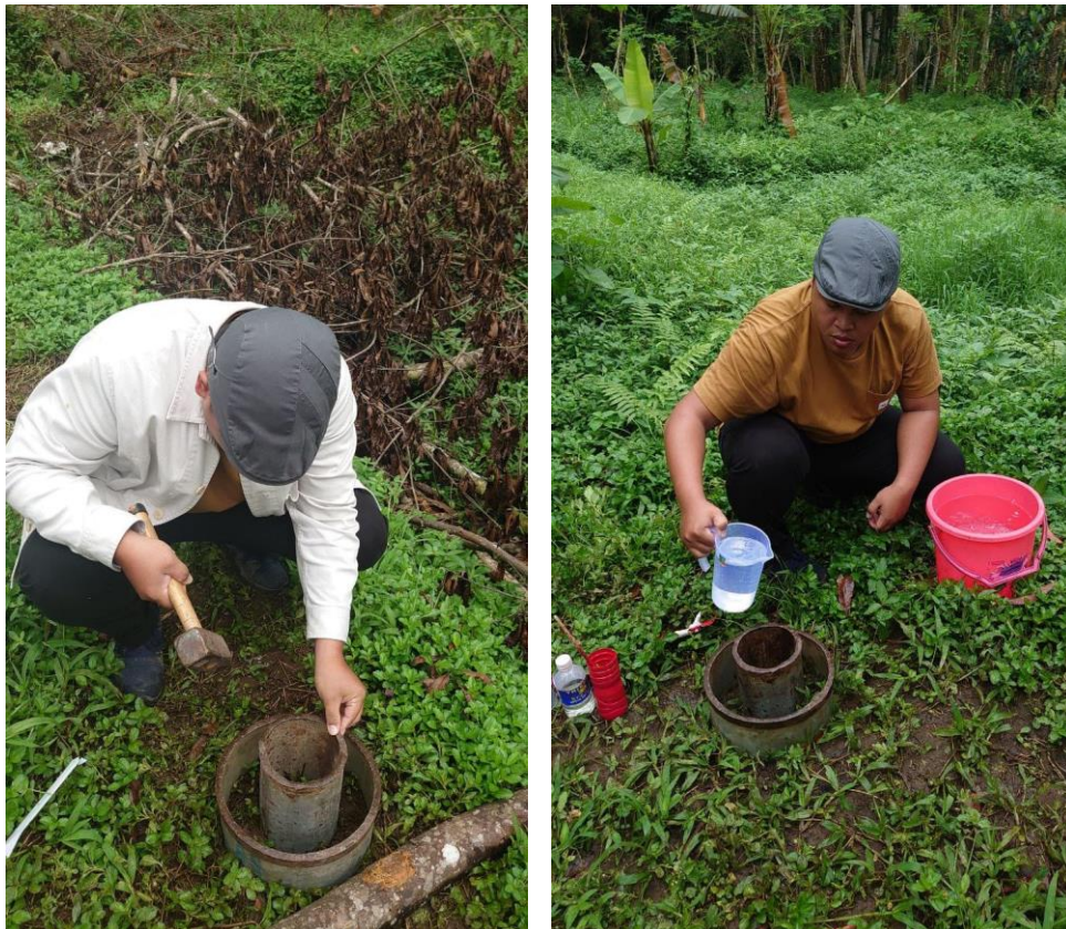
Gambar 11. Proses pengambilan data laju infiltrasi
